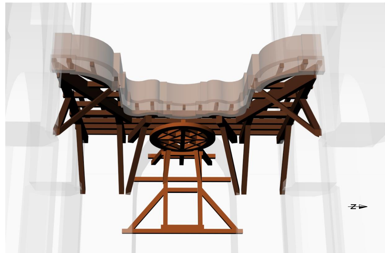
2 und 3: Ausschnitt: Orgelunterbau und Tragkonstruktion des Baldachins als Gegenstand der vorliegenden Untersuchung. Unten Digitalmodell der Konstruktion.
