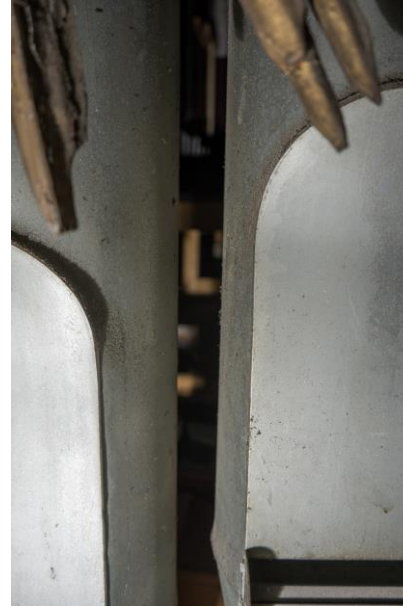
Hylotoxkristalle an den Orgelpfeifen
